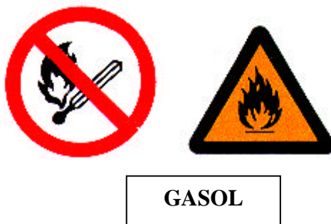
Bild 5: Förbuds- och varningsanslag för gasolcistern.
